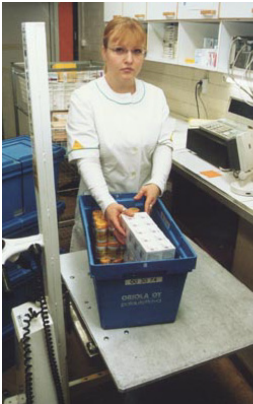
Nostolaitetta voi käyttää myös purkamisen yhteydessä. Nostolaitteen tason korkeutta voi säätää laatikon koon mukaan.
